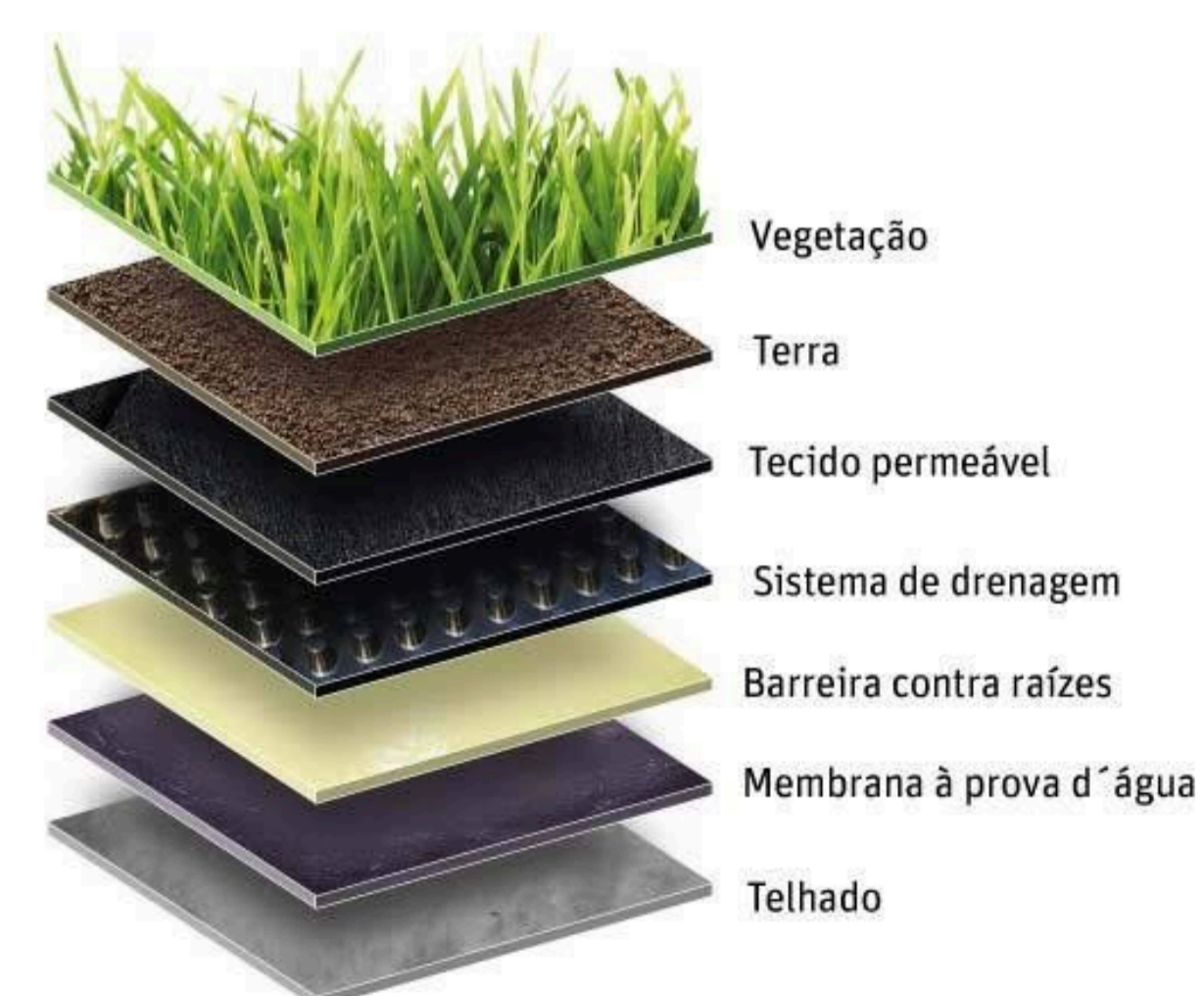
Camadas de um telhado verde
